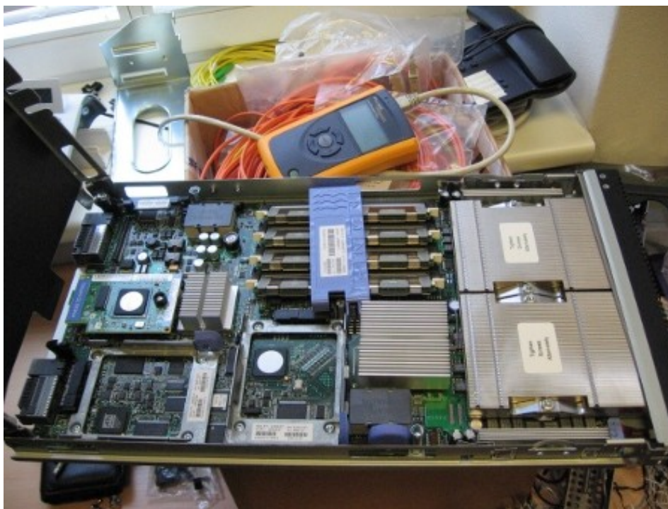
Obrázek 1 Jeden ze serverů (žiletok) systému IBM BladeCenter
